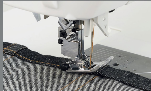
Подшивка низа изделия из толстой джинсовой ткани. Легко преодолевает швы на толстых материалах.
