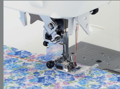
Шитье тонких материалов. Никакого стягивания даже при обработке тонких хлопчатобумажных тканей.
